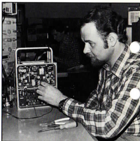
Jan-Erik (Tjalle) Carlsson provar ledningsförstärkare vid Vt 318.
