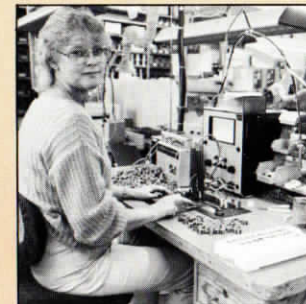
Gunilla Karlsson resonansjusterar och elmäter spolar.
