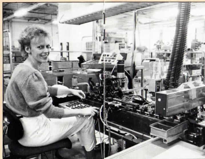
Lisbeth Lindgren sköter vår halvautomatiska maskin för montering av spolar.
