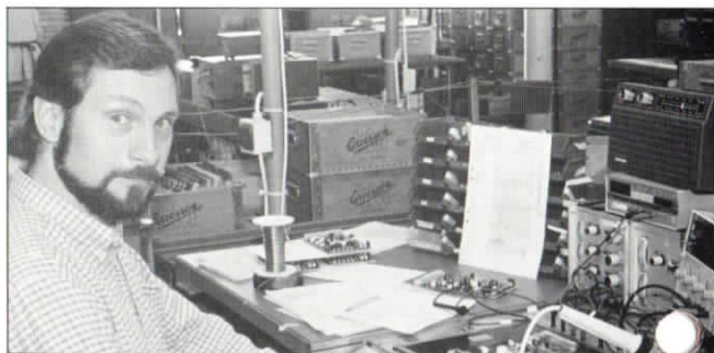
Peter Rydvall provar transformatornhet
