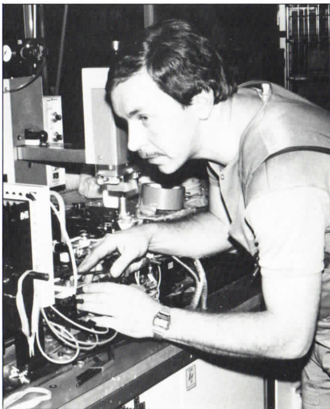
Börje Viklund monterar in ny provutrustning i monteringsautomat för REG 525.
