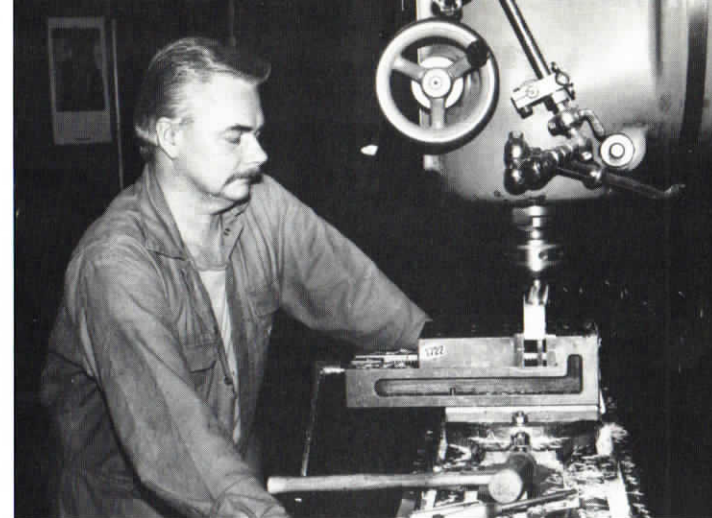
Jörgen Sjöberg fräser detalj till provfixtur.
